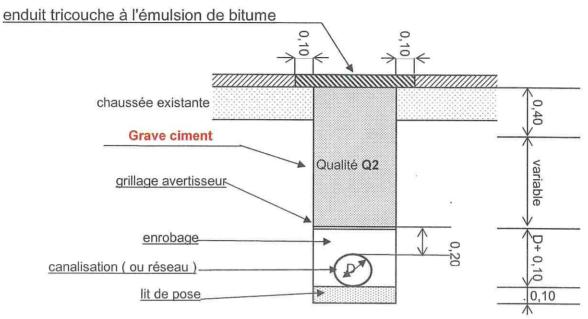
La qualité de compactage exigée pour une chaussée donnée est modulée en fonction du rôle de la couche au sein de l'ouvrage et trois niveaux de qualité sont ainsi déterminés pour les matériaux de remblaiement et les matériaux de chaussée.
